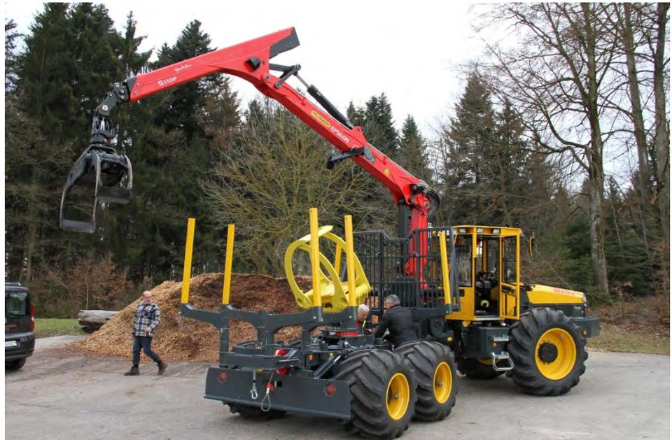
Der neue "Welte 130M" ist mit einer Doppelwinde, Rückezange und einem 10 m Kran ausgerüstet.
