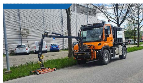
Mitarbeiter des Werkhofs Lyss bekämpfen Unkraut mit Heisswasser.
